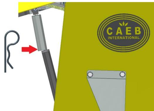
Fig. 12 Blocco dispositivo anti-chiusura
