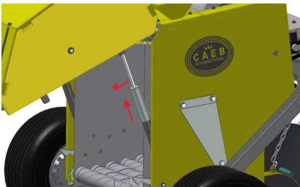
Fig. 11 Dispositivo anti-chiusura
